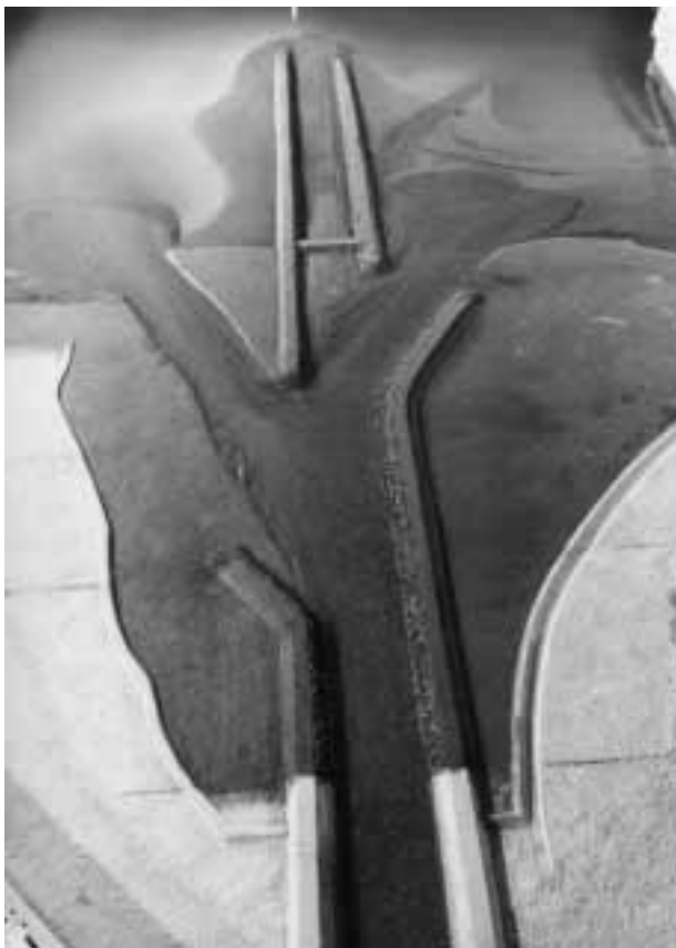
Abb. 9. Hydraulisches Modell der Reussmündung (Modellmassstab 1:70) nach Realisierung aller Phasen (Öffnung links und rechts, Querwerk im Vorstreckungskanal) (aus VAW, 1983)
