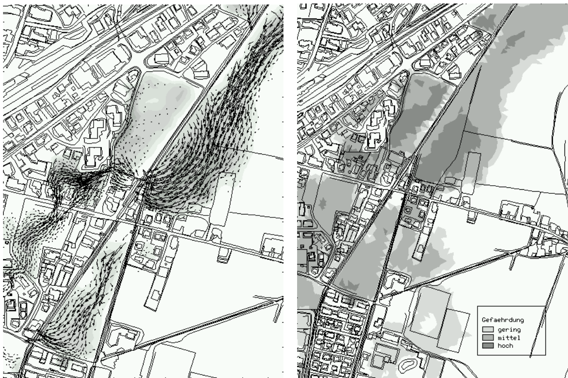
Abbildung 8 - Berechnete Flussvektoren und Abflusstiefen für ein 100jähriges Niederschlagsereignis mittlerer Dauer (links); modellierte Gefahrenstufen, Zustand 2001 (rechts)
